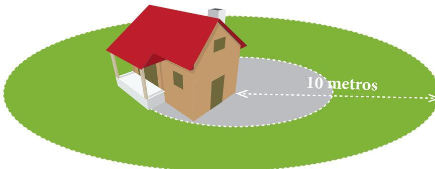
Figura 31. Esquema de la zona 2 o de protección de la casa.
